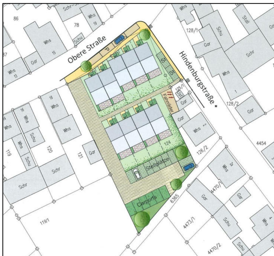
Städtebauliches Konzept für die Errichtung von Hausgruppen-Einheiten auf dem Flurstück Nr. 124, der Gemarkung Ubstadt
